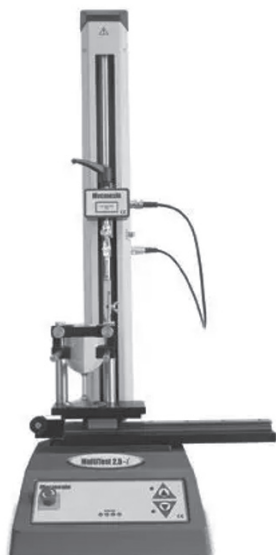
Фиг. 1. Апарат MultiTest 2.5-i (Mecmesin Ltd., UK) и изображение от софтуера на системата Emperor™
