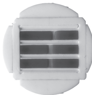
Фиг. 2. Опитни тела, подготвени за репаратура, Стандарт по ISO 20795-1
