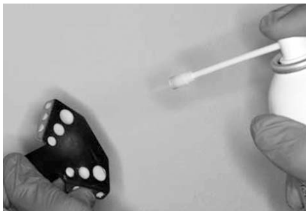
Фиг. 1. Излишъците от силикон се изрязват и металната повърхност се покрива с бял спрей, съставен от титанов диоксид
