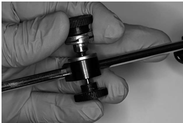
Фиг. 8. Винтът отдолу, който е под винта отгоре, се разхлабва и освобождава шарнирното движение на лицевата дъга.
