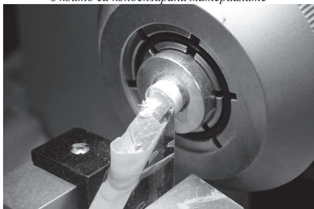
Фиг. 3. Полиране на образците с микротом и стъклен нож
