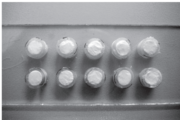
Фиг. 1. Полиетиленови цилиндрични форми, в които са кондензирани материалите
