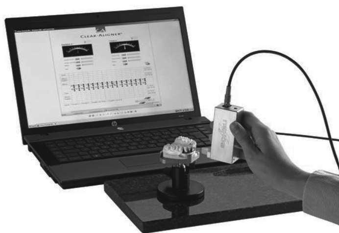
Фиг. 6. Лабораторен протокол за изработване на СА. Заснемане на модела и прехвърляне на електронен Checker за анализ и изработване на set-up. Електронно пренасяне на стойностите от set-up модела върху модела с отклоненията.
